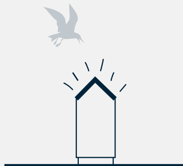
Fuglesikring Taghældningen sikrer, at regnvand ikke regner ned i åbning på skraldespand, samt at fugle ikke kan tilgå åbning
