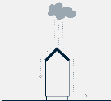
Hygiene og nedbørssikret Det hældende tag er selvrensende, samt sikrer at vand ikke regner ned i beholder. Taghældningen modvirker henstilling af affald på toppen
